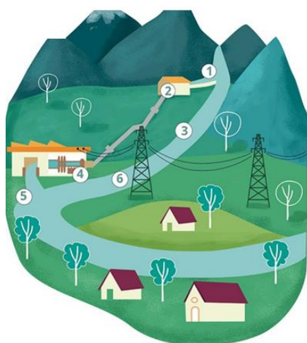
Figura 48: Esquema de operación de una central hidráulica de pasada
